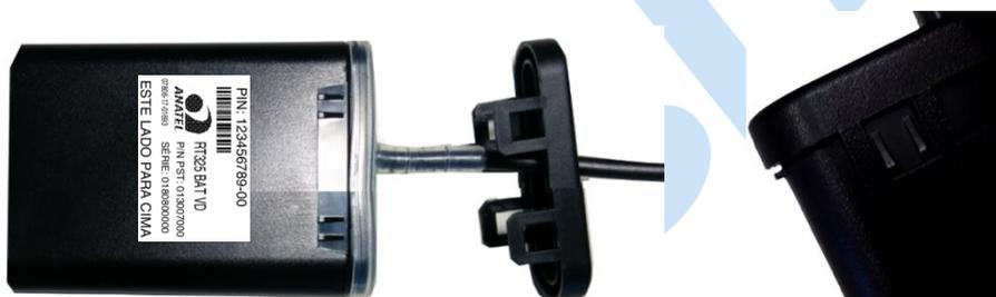
Para fechar o rastreador, posicionar primeiramente o Seal na caixa plástica.
